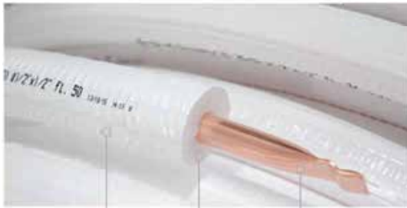
Capa externa de protección Tubería de cobre en el interior Aislamiento de espuma
